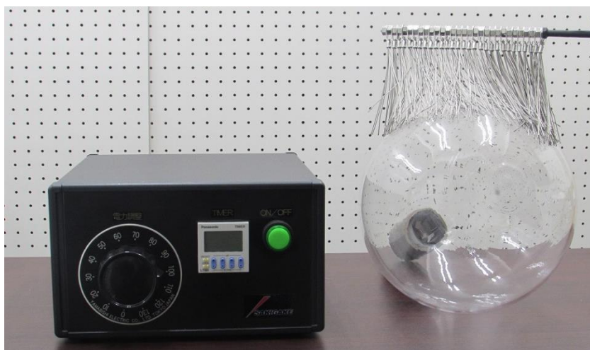
[写真]ブラシ型大気圧プラズマ表面改質装置「get a command of」を使った球状対象物の表面処理のイメージ
